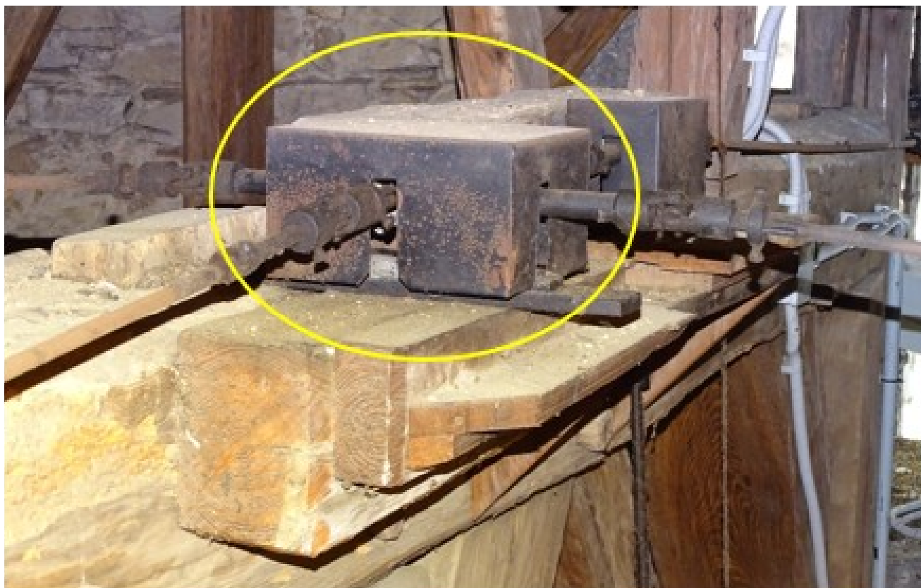
Tato nově dodaná centrální převodovka nahradí komplet stávajících novodobých převodů
